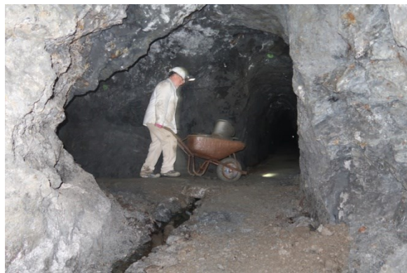
Transport von Bergematerial in die Versatzstrecke (B. Noltemeyer; Foto: J. Bertram, 12.08.2023)
