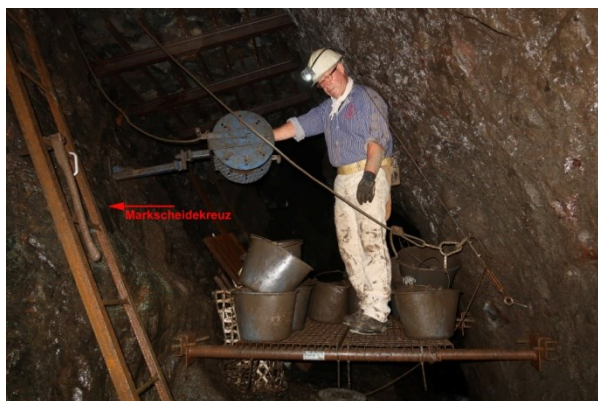
Untere Förderbühne im Niveau des St. Jacobsglücker Tagesstollens mit transportbereiten Eimern (D. Hochbaum; Foto: J. Bertram, 23.09.2023)
